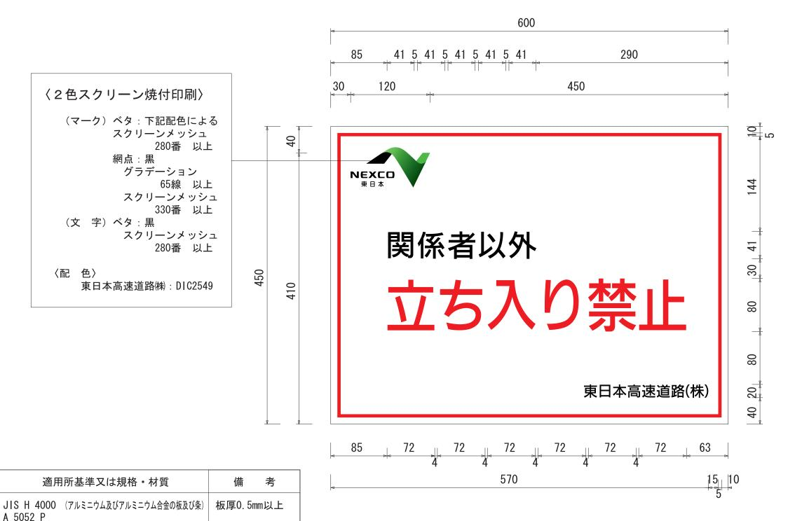
取付金具 JIS G 4305 (冷間圧延ステンレス鋼板及び鋼帯) 板厚0.5mm以上 SUS 304 リベット アルミ合金リベット リベット径3.2mm
